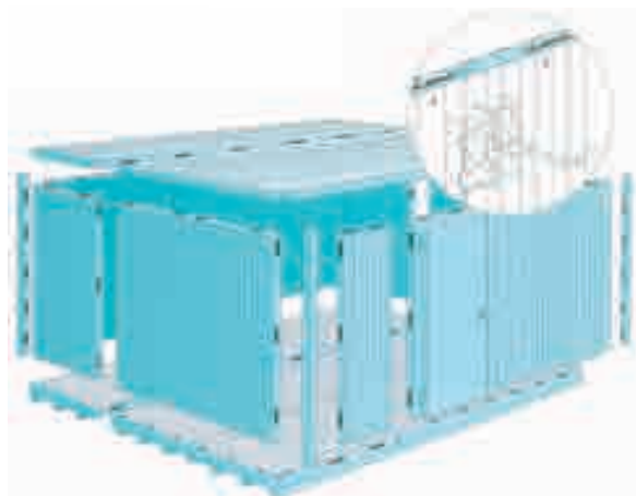
Assemblage des panneaux par crochets
